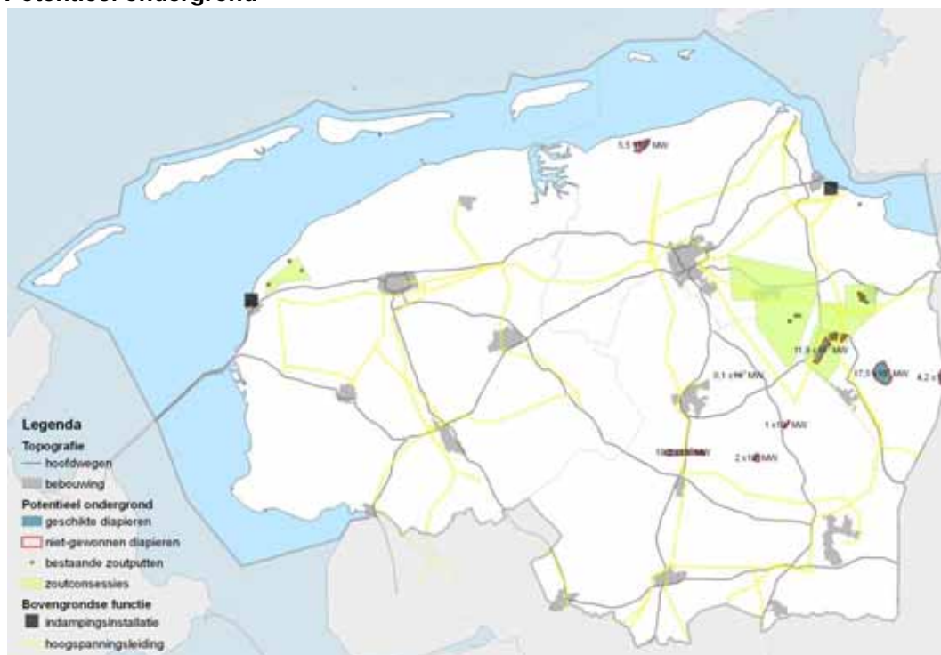
Figuur 2.20 Potentieel persluchtopslag in cavernes
