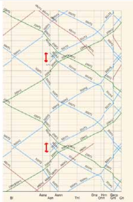
Figuur 15: Te korte tijd tussen aankomst en vertrek bij treindienst Groningen - Assen
