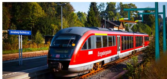
Abb. 2-26 Beispiel DB Erzgebirgsbahn EcoTrain mit Oberleitungs-Nachladung (Fotomontage) 47
