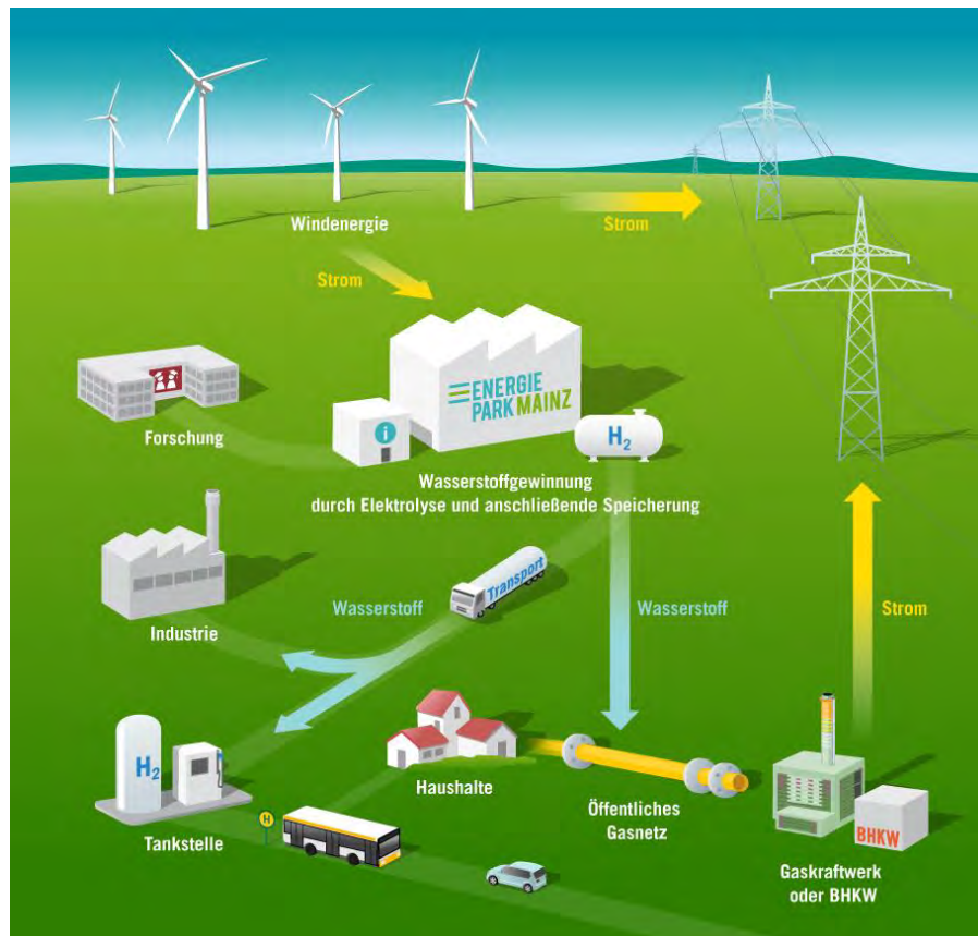
Abb. 4-2: Topologie des „Energiepark Mainz“ – Energieversorgungs-Möglichkeit aus dem öffentlichen Netz ist nicht dargestellt. 86
