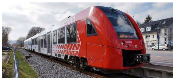
Abb. 2-5 Beispiel Neufahrzeug Alstom Lint 54, Baureihe 622 14
