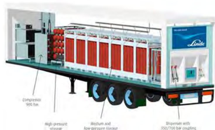
Abb. 4-5: Wasserstofftrailer mit integrierter Verdichtung und Dispensern. Quelle: Linde AG, 2016
