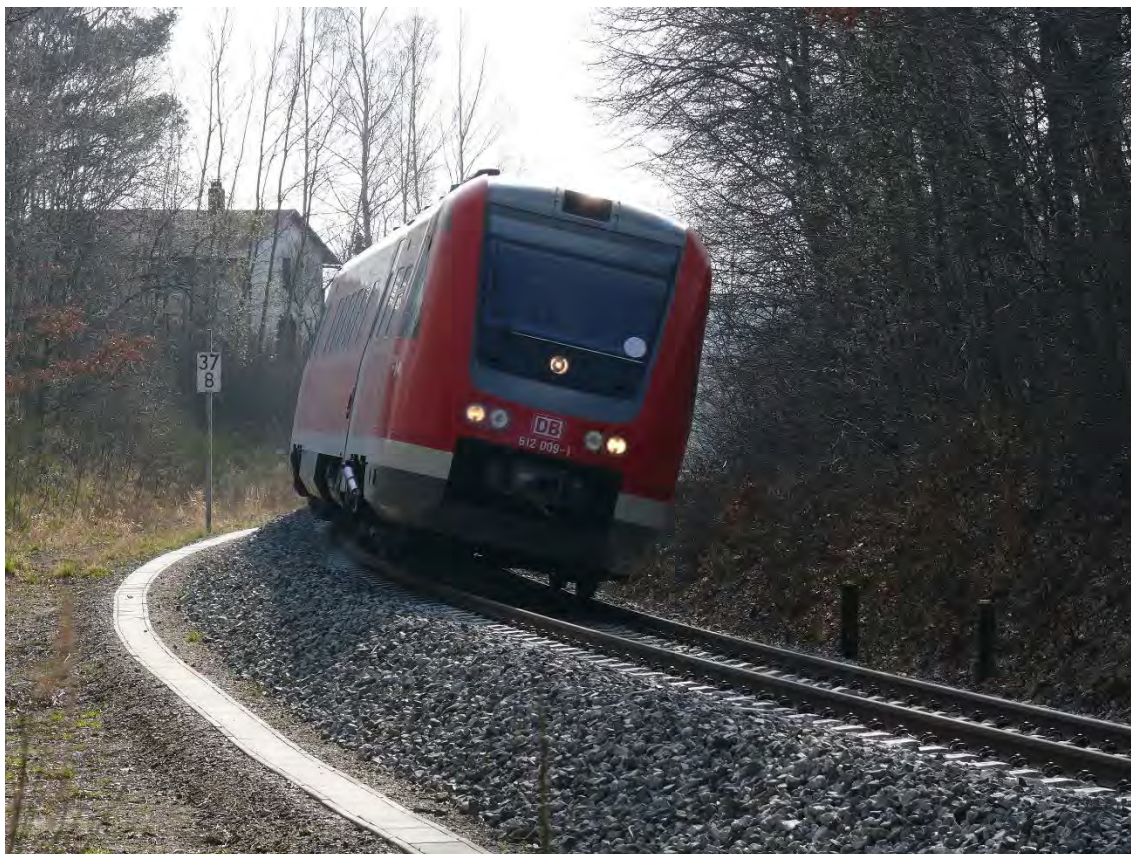
Abb. 2-32: BR 612 im Bogen mit deutlich erkennbarer Neigung 67
