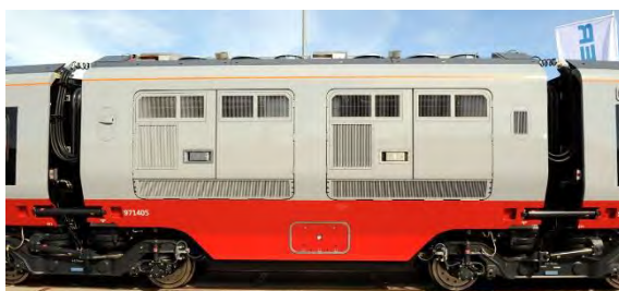
Abb. 2-21 Unterbringung der Komponenten der 2. Traktionsart in weiterem Wagenkasten 43
