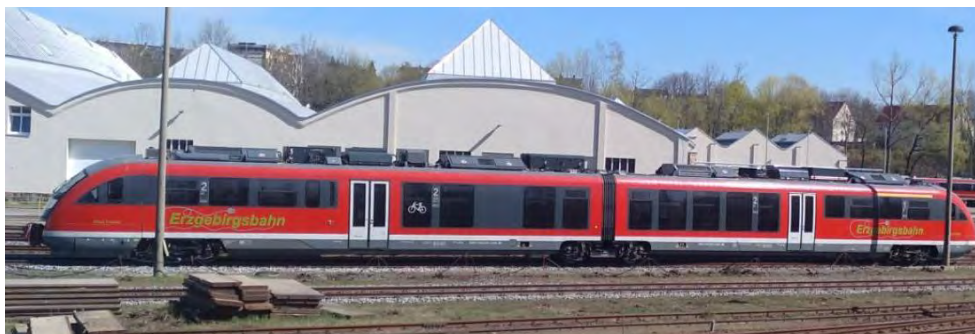
Abb. 2-27 Eco Train mit deutlich erkennbarem zusätzlichem Dachaufbau 48
